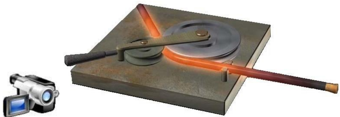
Fig.8.4.1.11.Îndoirea țevelor la cald
