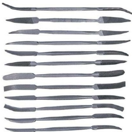
Fig. 7.2.5. Pile de uz special
